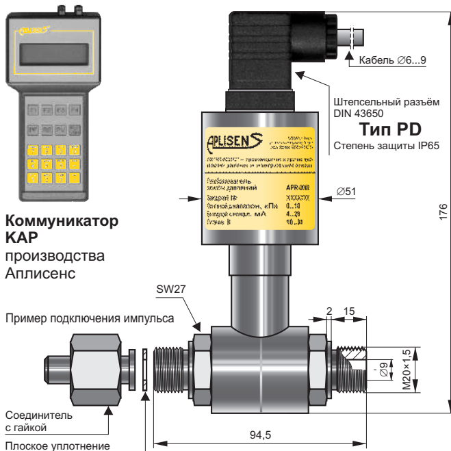
APR-2000PD с присоединительным устройством типа Р (для подвода импульсных трубок) Предельно – допускаемое рабочее статическое давление 4 МПа
